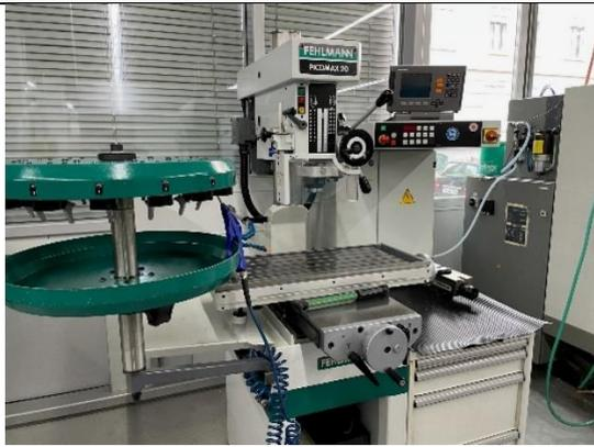
**1. Koordinaten-Bohrmaschine: Fehlmann Picomax 20**
