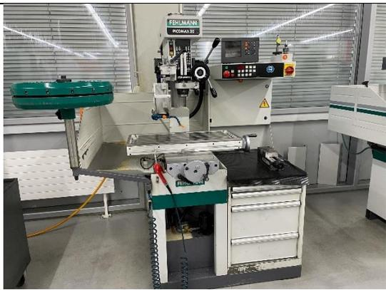
**2. Koordinaten-Bohrmaschine: Fehlmann Picomax 20**
