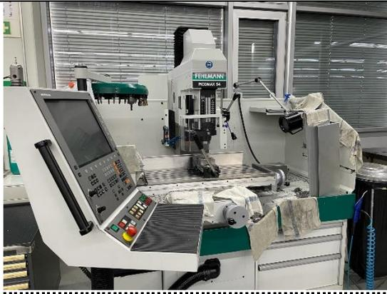
**Präzisions Fräs-und Bohrmaschine Fehmann Picomax 54 Top**
