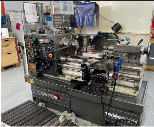
**Drehmaschine: Colchester Triumph 2500 VS (alt)**
